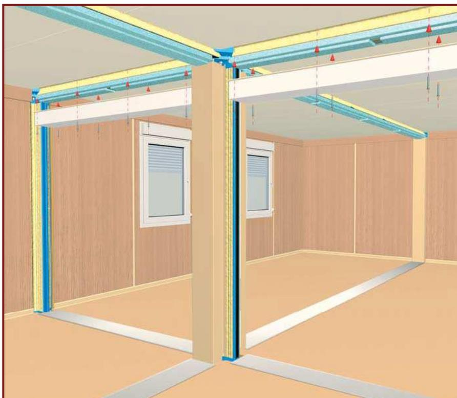
**DE:** Stirnseitige Seitentunnel mit aufgesetzter Lippendichtung, beginnend mit dem unteren Teil auf die bereits montierten Seitentunnel anschrauben.
