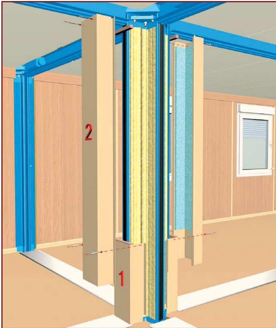
**DE:** Obere Seitentunnel in Position bringen und wie dargestellt mit den Holzleisten und unteren Tunneln verschrauben.
