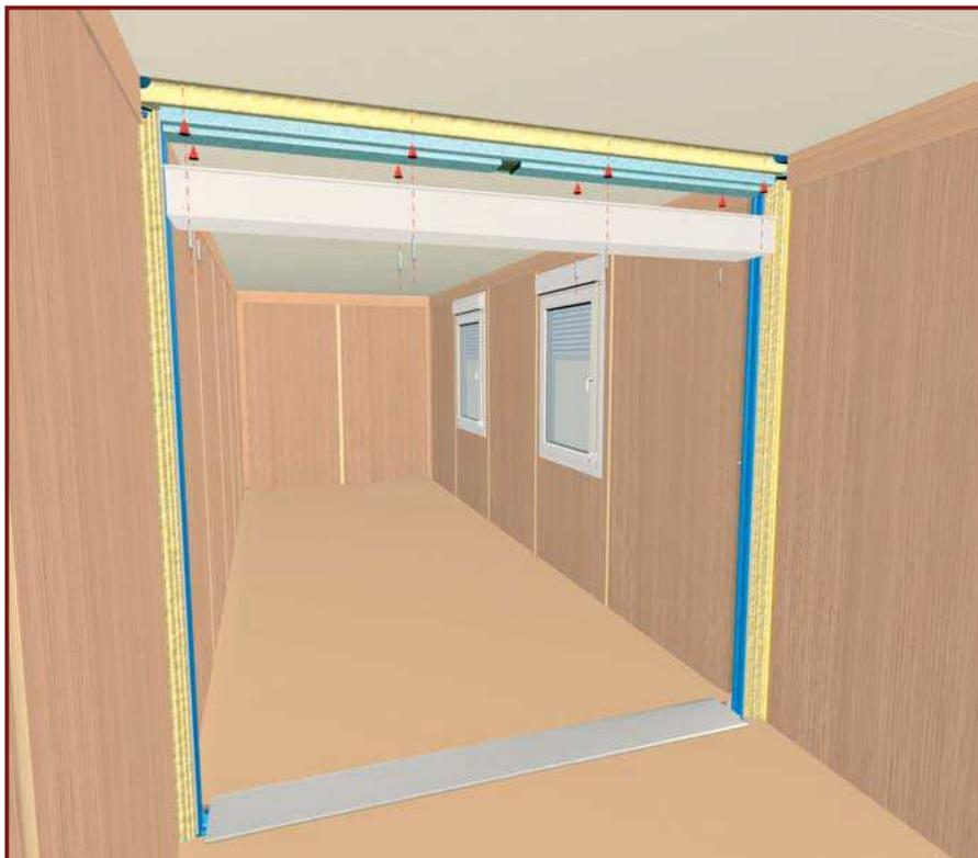
**DE:** Dachtunnel mit aufgesetzter Lippendichtung montieren.
