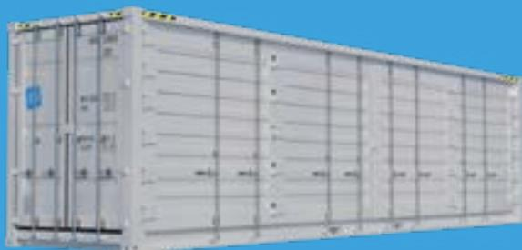
Le conteneur 40 pieds High Cube Open Side est doté d'une ouverture complète sur la longueur avec ses portes à doubles battants. Il dispose aussi d'une double porte à l'extrémité. Fabriqué en acier corten, il est étanche, robuste, et possède des coins ISO pour la manutention. Il offre 15% de volume en plus avec ses 30cm de hauteur supplémentaires.
